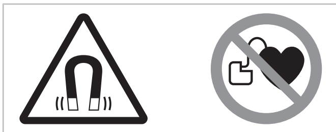
Рис. 8: Предупреждающие и запрещающие знаки на компрессоре с мотором с постоянными магнитами
