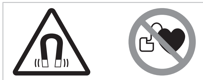
Рис. 1: Предупреждающие и запрещающие знаки на компрессоре
