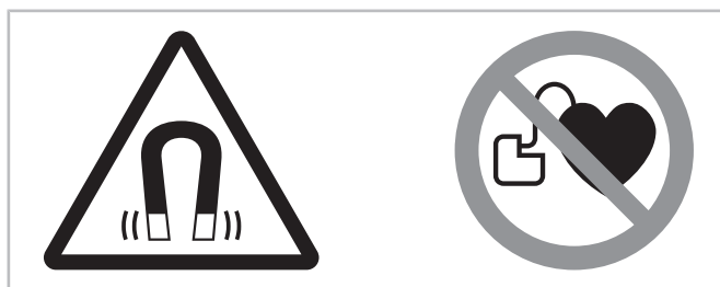
Рис. 1: Предупреждающие и запрещающие знаки на компрессоре
